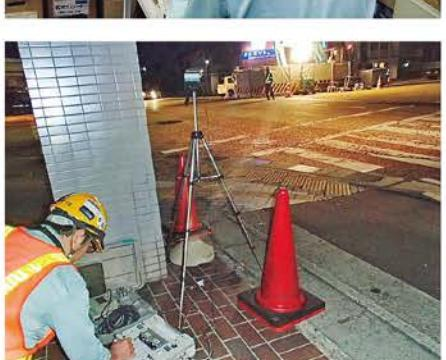
■騒音・振動測定調査(特定工場に係る騒音・振動測定)／指定地域内に特定工場等(特定施設(騒音規制法施行令第1条、振動規制法施行令第1条)を設置する工場又は事業場)を設置している事業者は、当該特定工場等に係る規制基準を遵守しなければなりません。
